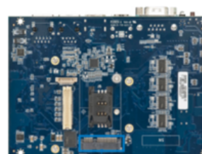
EMIO-2531 miniPCIe Wi-Fi + BT Module 802.11b/g/n standards Bluetooth 2.1 + EDR specification
